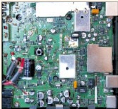
Bild 7: Blick auf das SMD-dominierte Innenleben des IC-2800H
